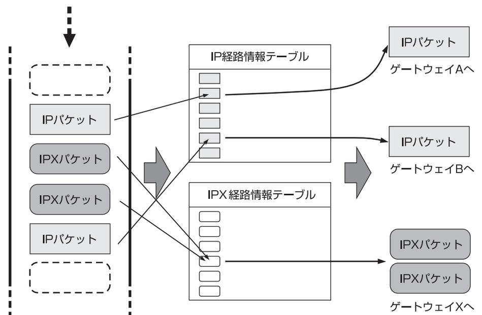
これらの経路情報テーブルは、管理ユーザが直接設定することができます。この情報はスタティックルーティングになります。経路情報をルーター間の通信により自動的に構築させるものをダイナミックルーティングと呼びます。本機では、ダイナミックルーティングの protocols として IP パケットに対して RIP、RIP2、OSPF、または BGP を使用することができます。IPv6 パケットに対しては RIPng プロトコルをサポートします。IPX パケットに対しては RIP プロトコルをサポートします。スタティックルーティングとダイナミックルーティングを同時に使用することも可能です。
